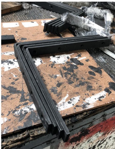
Forjado de anclas para señalética.
