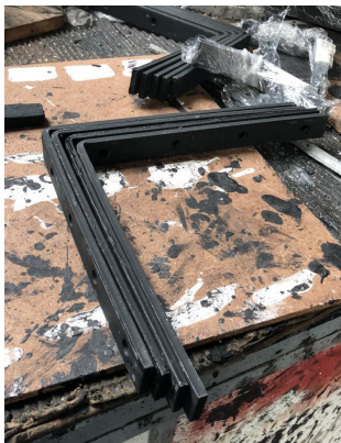
Continúa el forjado de anclas para señalética.
