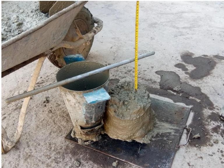
**PRUEBAS DE REVENIMIENTO AL CONCRETO PREMEZCLADO UTILIZADO EN OBRA**
