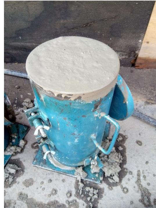
**ELABORACION DE CILINDROS DE CONCRETO PARA PRUEBAS A COMPRESION**
