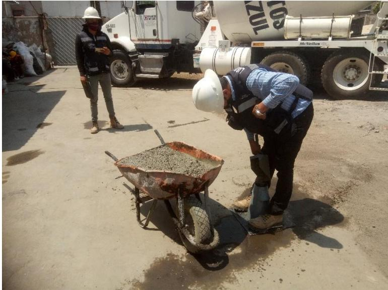
**PRUEBAS DE REVENIMIENTO AL CONCRETO PREMEZCLADO**
