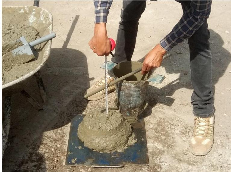
**PRUEBAS DE REVENIMIENTO AL CONCRETO PREMEZCLADO**
